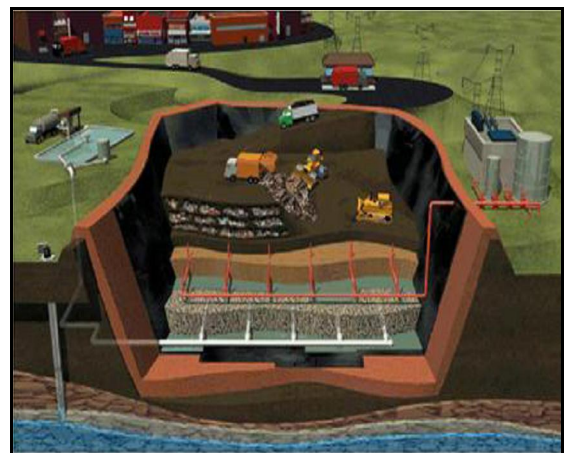
ภาพที่ 6 แสดงลักษณะของระบบกำจัดขยะมูลฝอยโดยใช้หลุมฝังกลบ
